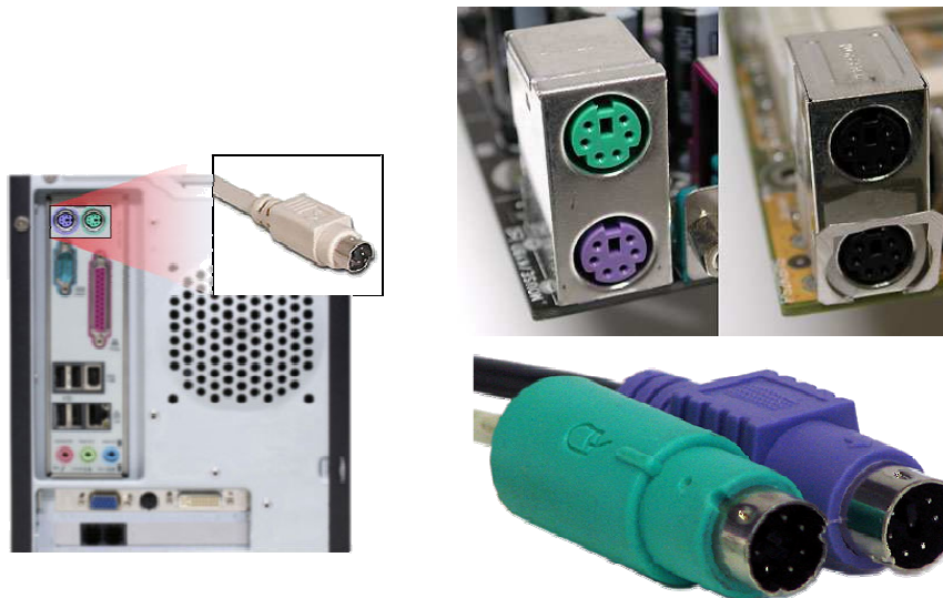
ภาพที่ 2-1 แสดงตัวอย่างของพอร์ตอนุกรมแบบ PS/2 ที่ใช้งานกับเมาส์ และคีย์บอร์ด
