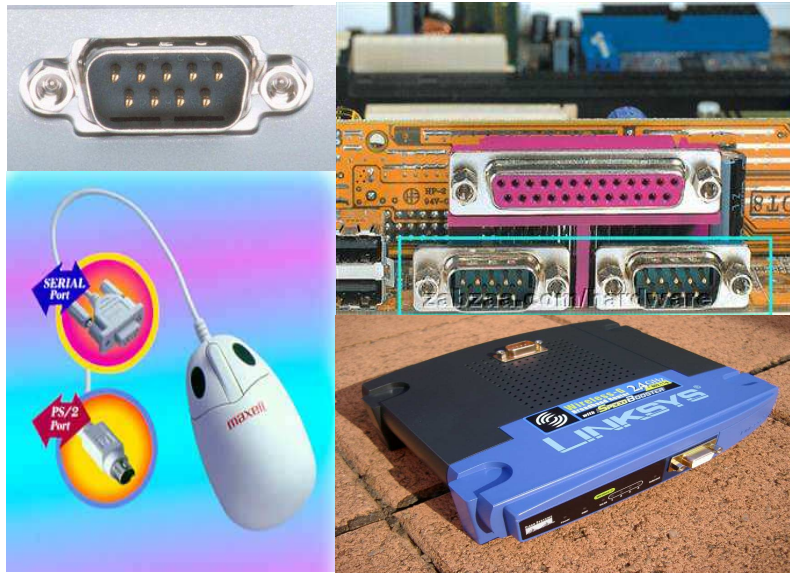
ภาพที่ 2-2 แสดงตัวอย่างของพอร์ตอนุกรมที่ใช้งานกับเมาส์ และโมเด็ม
