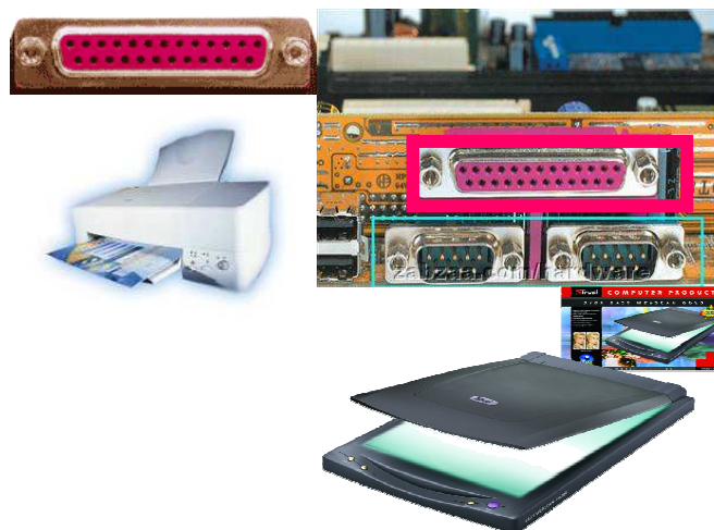
ภาพที่ 2-3 แสดงตัวอย่างของพอร์ตขนานที่ใช้งานกับเครื่องพิมพ์ และสแกนเนอร์
